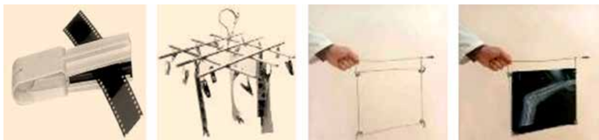
تصویر ۱۸: عملیات ظهور و ثبوت دستی فیلم رادیولوژی (24x30cm) و فیلم عکاسی (35mm) به همراه گیره و انبرک مربوطه، در تاریک‌خانه (نگارنده)
